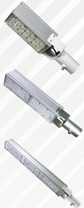
**Корпус** - цельнометаллический алюминиевый, изготовлен методом экструзии с последующим анодированием, площадь охлаждения поверхности светильника 0,2 м<sup>2</sup>.
